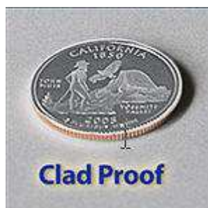
Ilustración 4- Moneda Clad con el canto bicolor (níquel/cobre/níquel)
