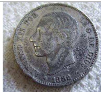
Ilustración 17 – Falsa en calamina sin baño de plata
