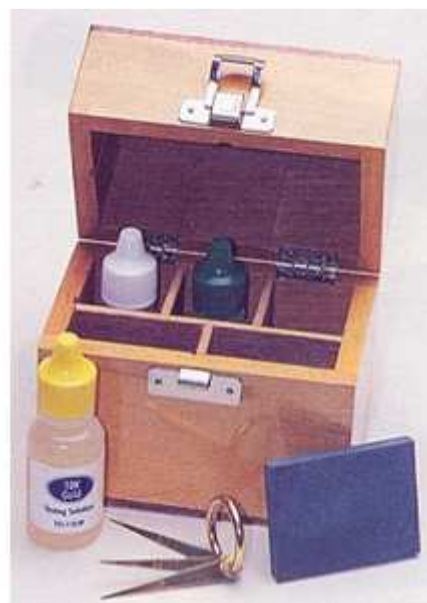
Kit test del oro, con ácidos para detectar diferentes quilates y piedra arkansas
