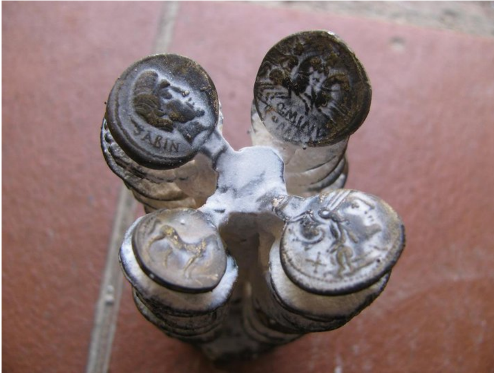
Ilustración 3 - Árbol de fundición con copias de denarios de plata. [REMONEDA]
