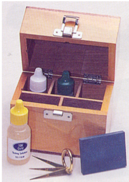
Ilustración 5- Kit test oro con ácidos para detectar diferentes quilates y piedra arkansas.
