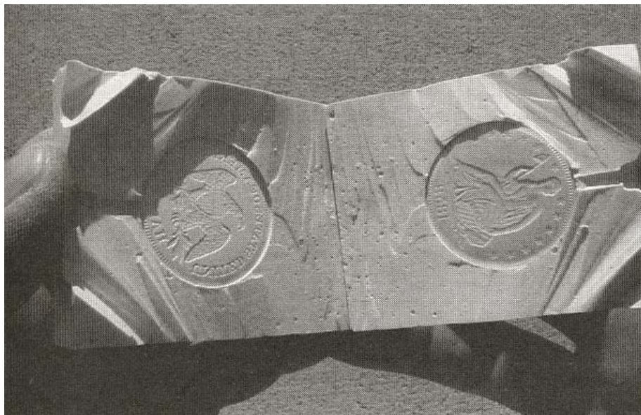
Molde de goma empleado para producir una falsificación por microfusión
